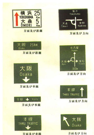
高速道路の案内標識は基本的に緑と白。一般道は濃紺と白で表示された。
