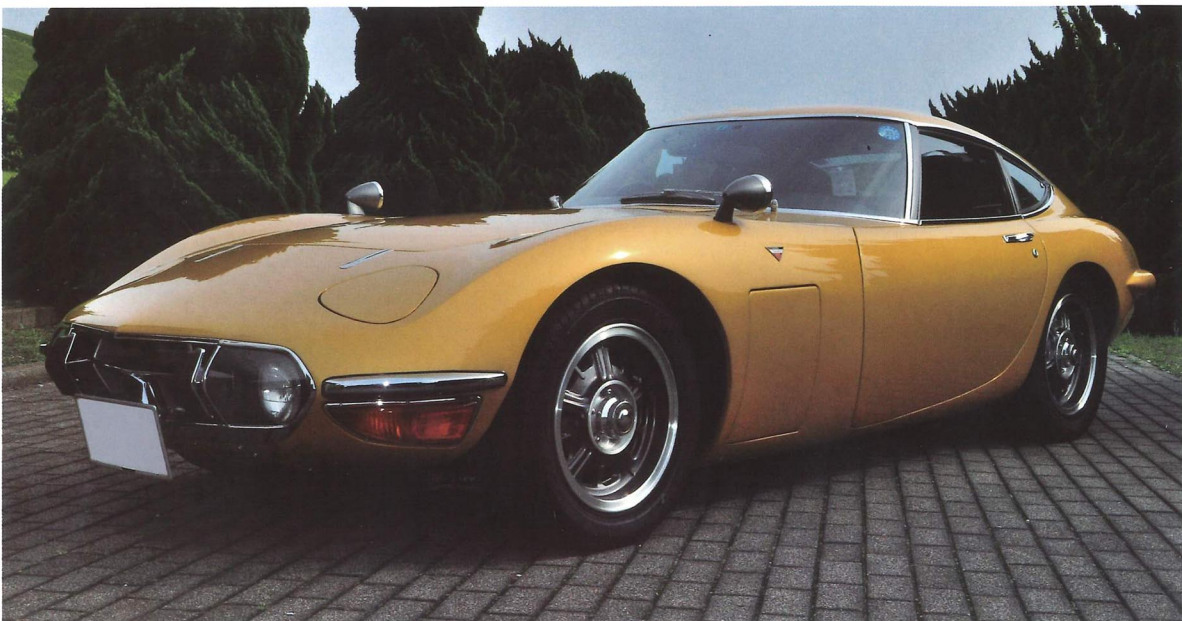
1969 (昭和44) 年8月に2000GTは最初で最後のマイナーチェンジを実施。フロントマスクまわりが一段とスリークになりラジエータの材質が鉄からアルミに変更された。
