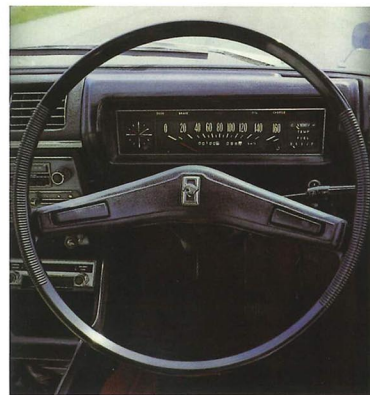
パッド付きダッシュボード&ステアリング、脱着式ルームミラーなど77項目におよぶ安全対策を施した。
