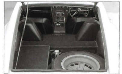
ホイールはスベア用も軽量のマグネシウム製。シート背後に大きく突きだしているのは、リアサスペンションのアップアーマウント。
