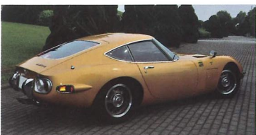
安全基準の改定に合わせ後期型はリアのサイドマーカを大型化。写真のボディカラーは1967年の東京モーターショーに展示されたモデルと同様の特別色のゴールド。
