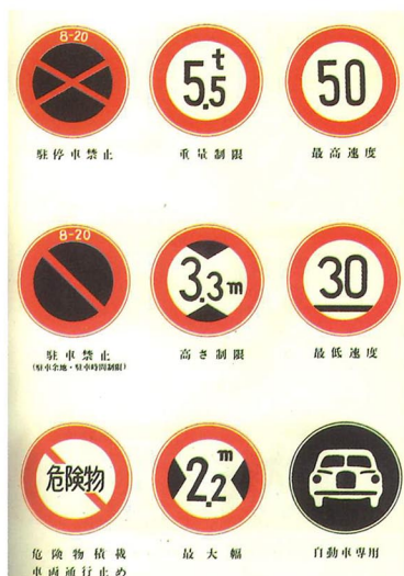
規制標識は円形。禁止事項は赤色で示される。円形の直径は600mm。
